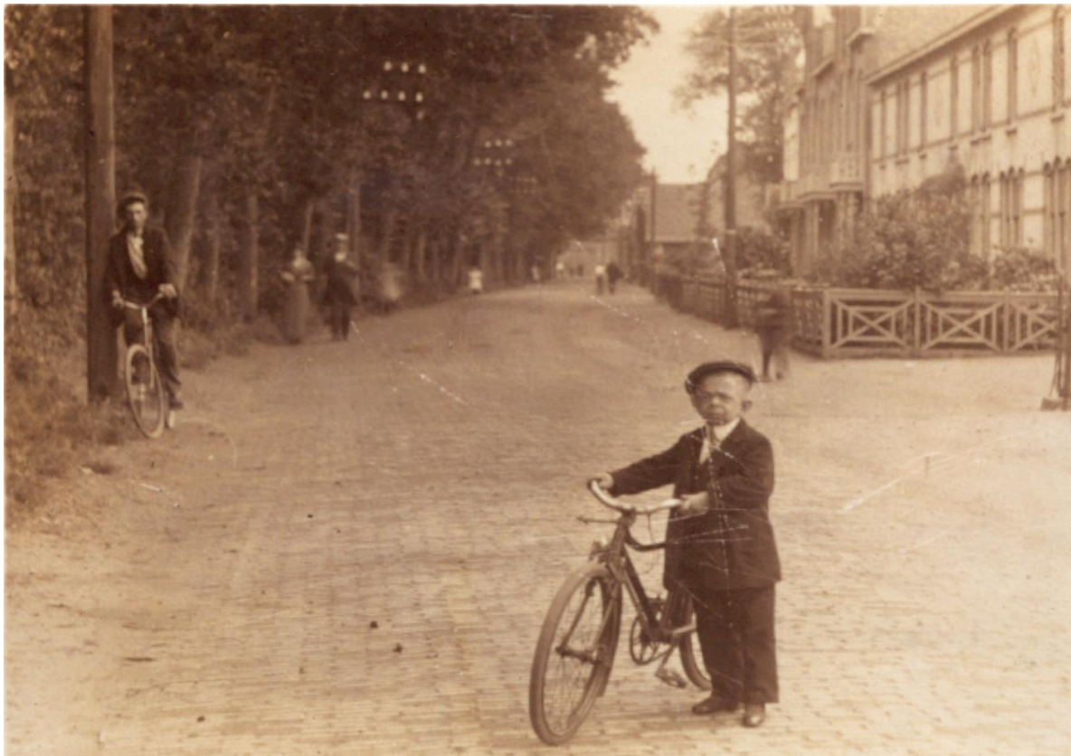
Ca. 1910 Utterlike kenmerken: manly-fytsy, gyn foorlamp, gyn bel, knik in de stang feerder horisontaal , knyprem ? en open kettingkas.
